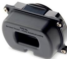
半球高音振膜，再結合最新一代IAL（Infinite Acoustic Loading / 無限聲學負載）技術IAL3，以及IHL（Infinite Horn Loading / 無限號角式負載）技術，兩者均提高了聲波的吸收率，從而改善高音的共振頻率，使之可有效延伸至40kHz，即盆分裂（共振頻率）更遠離人耳可聽頻之下，可聽頻以內的工作表現就更精確。高音單元背後被一個開有導管並有填充阻尼物的盒子罩著，IAL 3利用泡沫材料吸收高音振膜的背波能量，而IHL之技術下，高音振膜的背壓能量經盒子背的號角式導管收集並送出，穿過由窄而闊的號角式導管、逐漸減壓後才排出。可以講，將因背壓能量回輸而衝擊振膜，影響其活塞動作的機率，減至幾近零。
