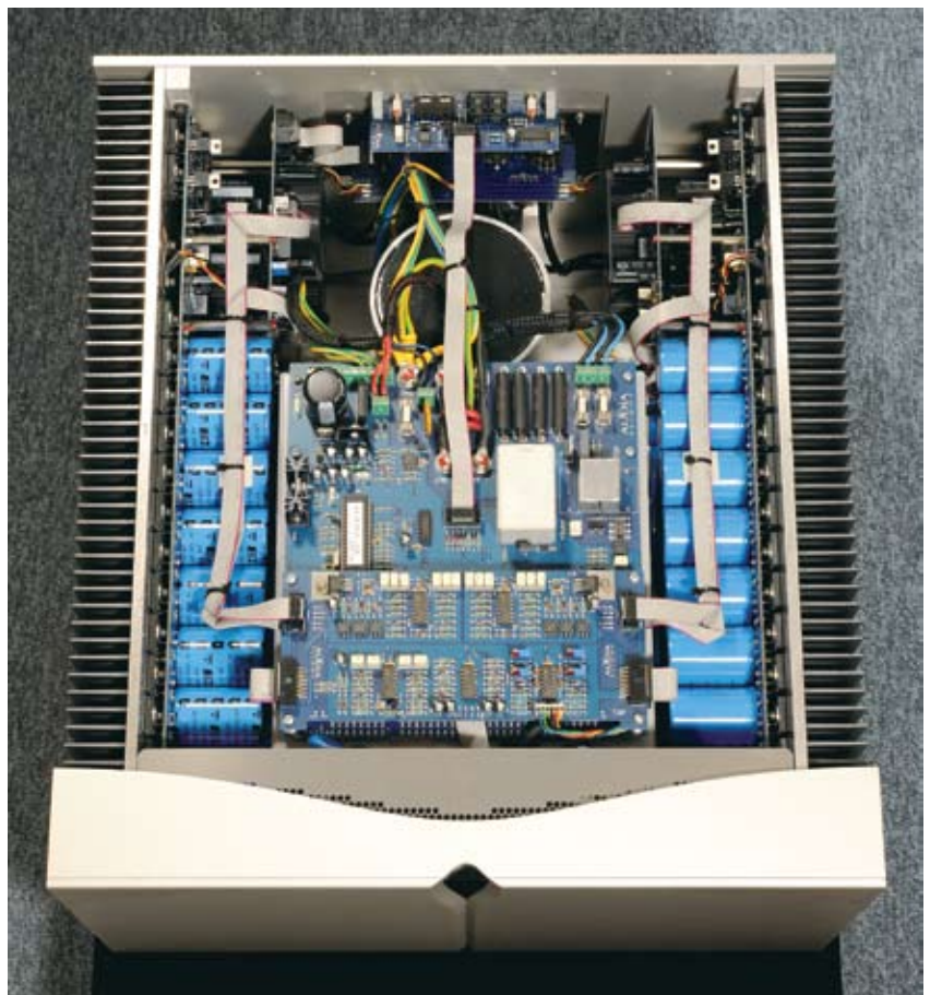
△置於機箱中央是控制電路板，下面是以雙重屏蔽供電給輸出級的 3000VA 電源變壓器。
